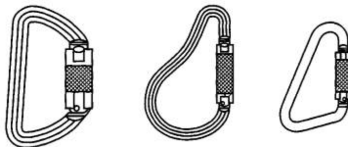
Рисунок 1 - Пример базового соединительного элемента (класс В)
