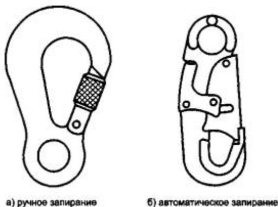
Рисунок 2 - Пример конечных соединительных элементов (класс Т)
